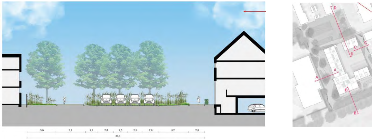
Figuur 17 Doorsnede profiel DD over het Keggeplein.
