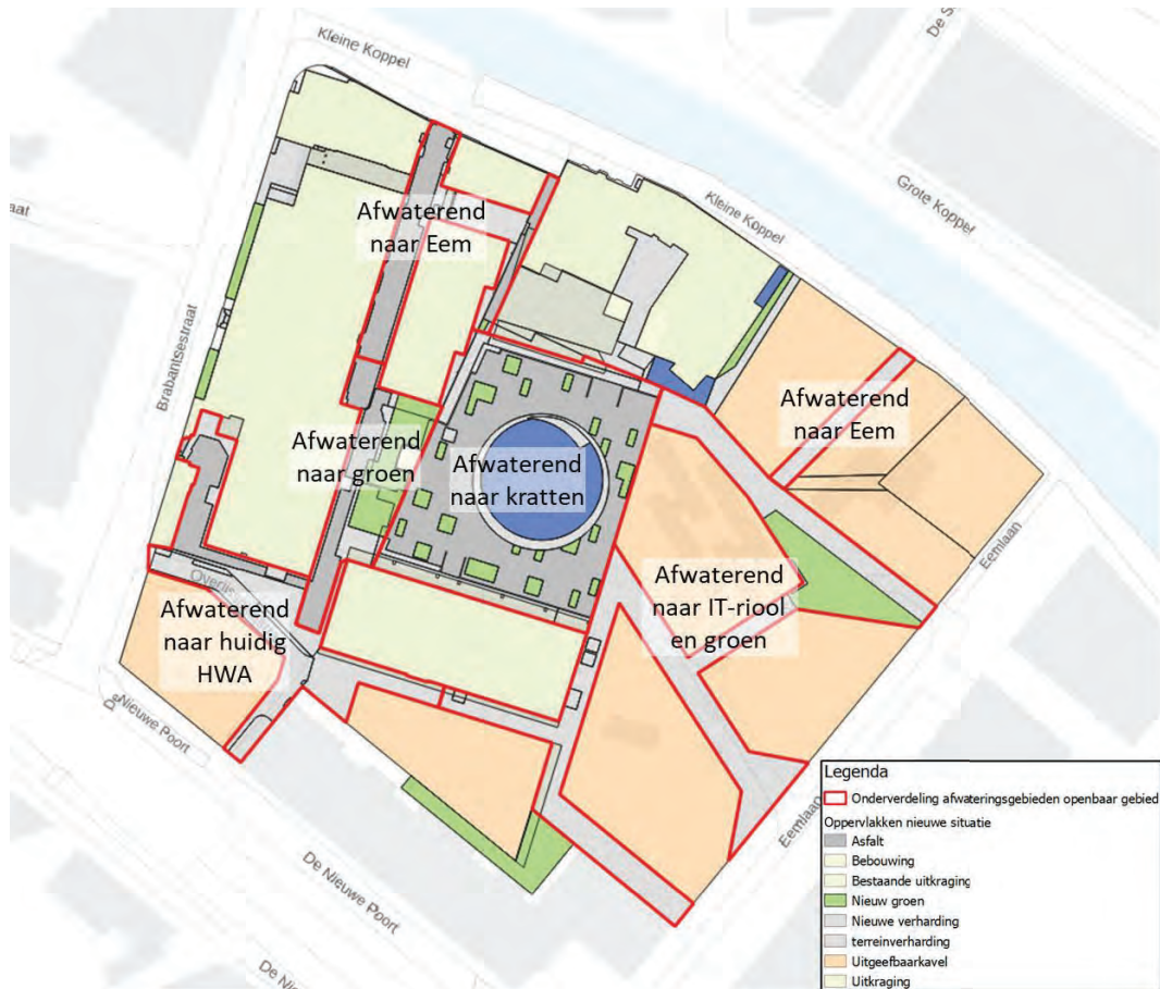
Figuur 4-2: Onderverdeling afwateringsrichtingen openbaar terrein
