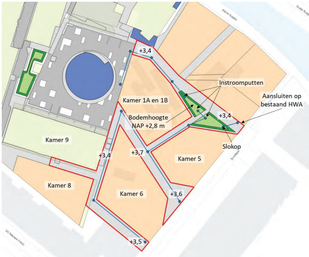
Figuur 4-8: Afwaterend oppervlak via IT-riool en infiltratieveld (incl. hoogtes in m +NAP)
