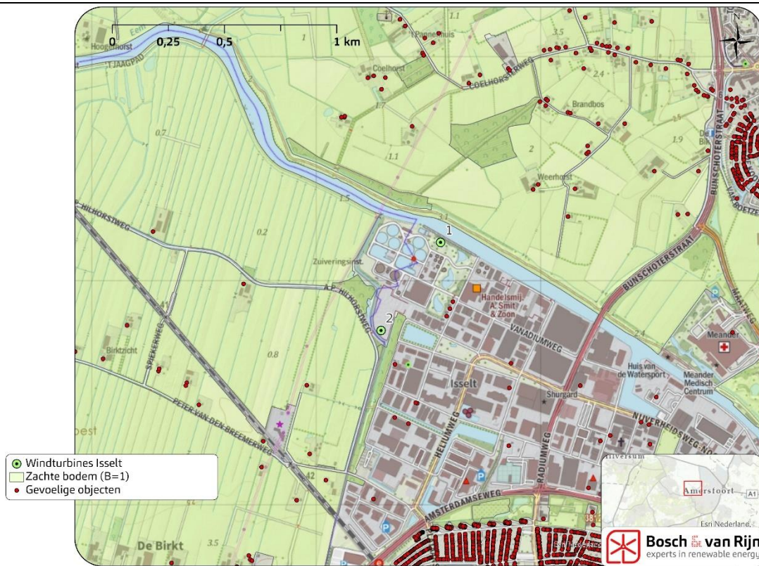
Figuur 2 Bodemabsorptie en –reflectie rondom de windturbines. Bron: Bestand Bodemgebruik 2012. Standaard is gerekend met een harde, reflecterende bodem (B=0). Gebieden met een zachte bodem (groen in onderstaande figuur) zijn als absorberend (B=1) opgenomen in de berekening.
