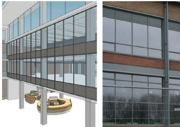
3D ontwerp van een centrale hal op basis van door Repurpose bij Lek Mining gevonden herbruikbare aluminium puien.
