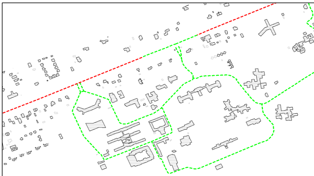
Wegdektypen: dichtasfaltbeton (groen) en SMA 0/8G+ (rood)
