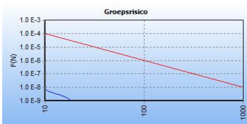
5.5 Figuur 5.5 FN curve voor 6993_leiding-W-500-05-deel-1 van N.V. Nederlandse Gasunie voor de kilometer tussen stationing 0.00 en stationing 0.00
