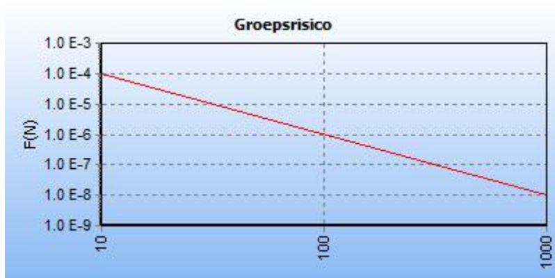
5.8 Figuur 5.8 FN curve voor 6993_leiding-W-520-01-deel-1 van N.V. Nederlandse Gasunie voor de kilometer tussen stationing 0.00 en stationing 1000.00
