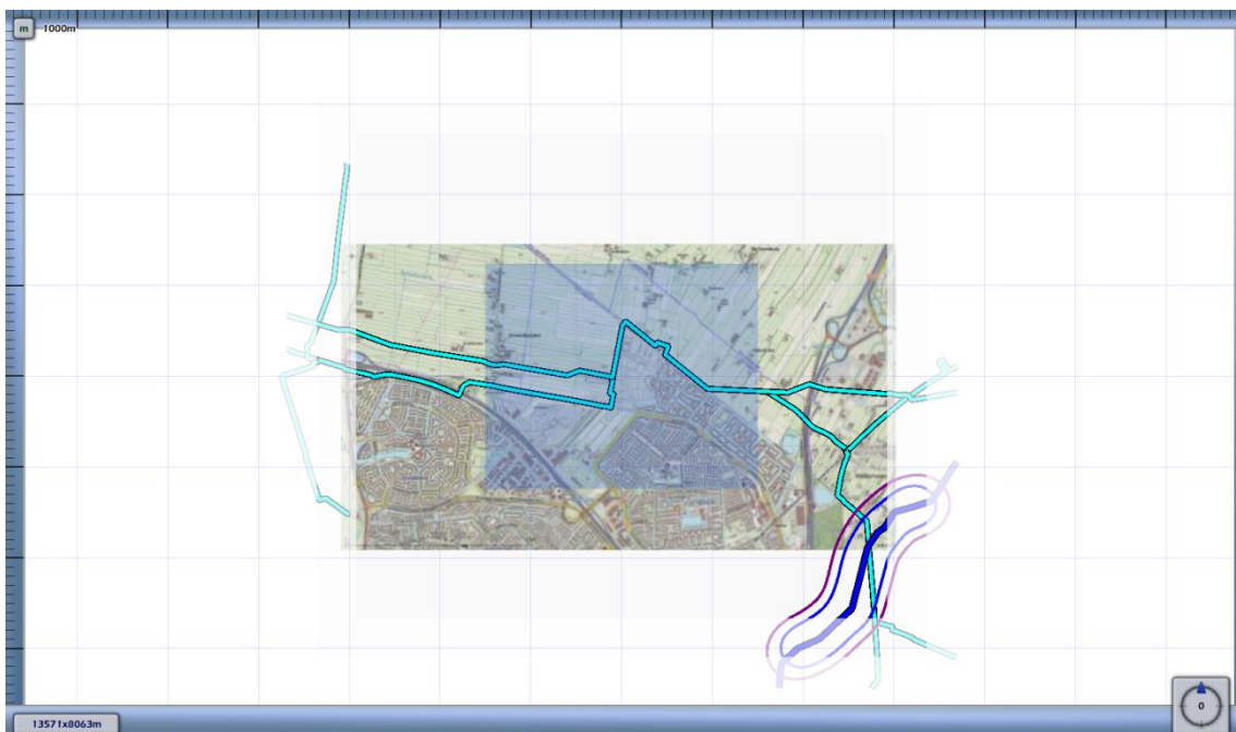
3.2 Figuur 3.2 Plaatsgebonden risico voor 6993_leiding-A-510-deel-1 van N.V. Nederlandse Gasunie
