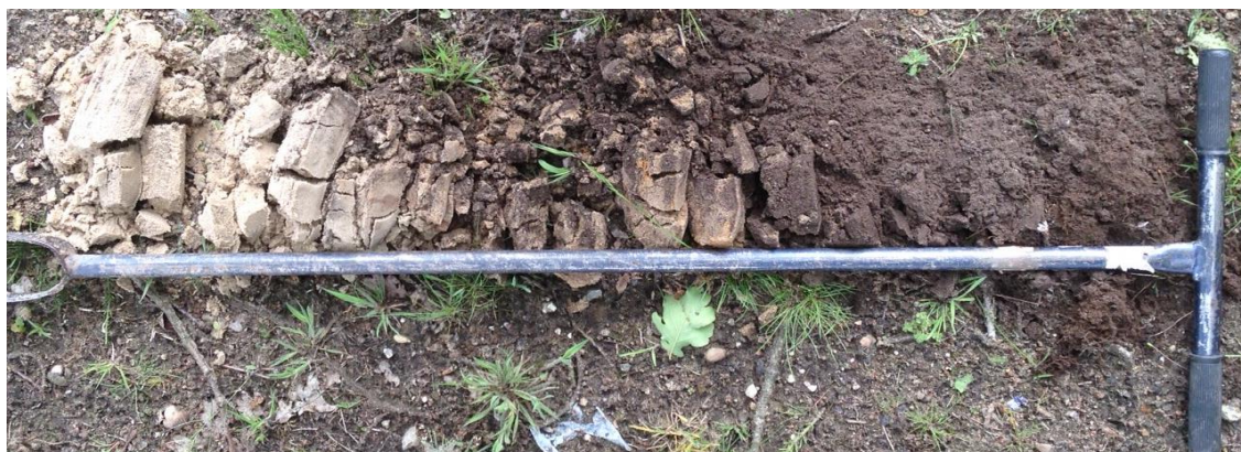
Afbeelding van grondboor met uitkomend grondprofiel
