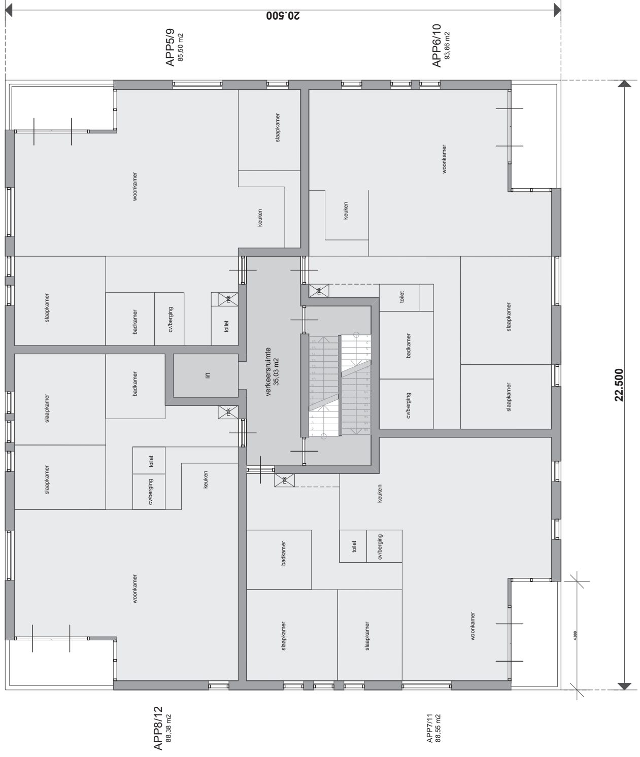
Plattegrond 1e en 2e verdieping - schaal 1:100
