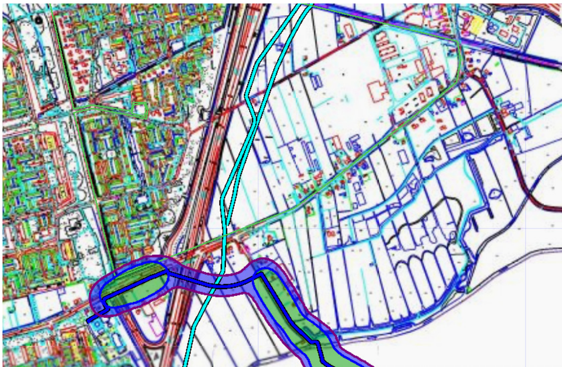
Figuur 3.3 Plaatsgebonden risico voor W-520-05 van N.V. Nederlandse Gasunie
