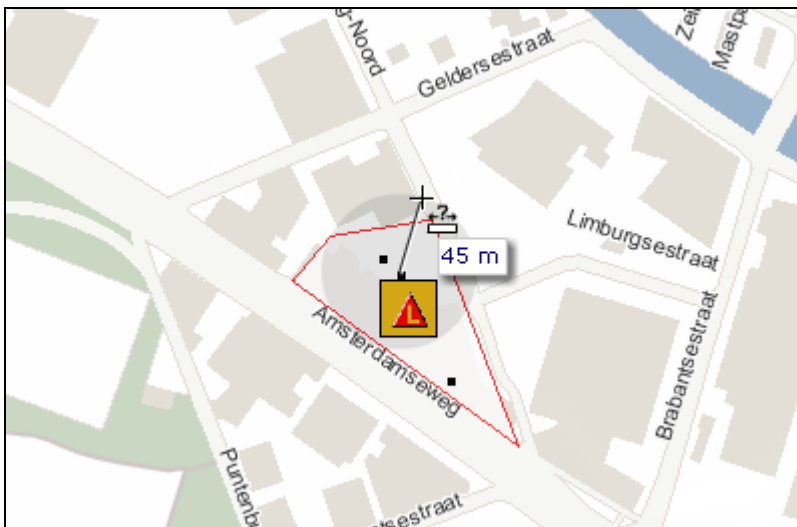
Figuur 4: 45 meter contour rondom het vulpunt van Shell Serva B.V. (doorzet <1000 m 3 )
